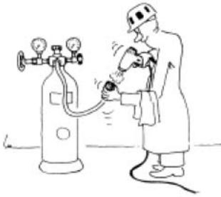
Zu beachten ist, dass jedes Material schrumpft, wenn es tieferen Temperaturen ausgesetzt wird. Das Ausmaß der **Schrumpfung** ist abhängig vom Material und vom Grad der Temperaturabsenkung. Unterschiedliche Schrumpfungen unterschiedlicher Materialien können zu Leckagen oder auch zu Brüchen, z.B. an verschraubten Flanschen oder ähnlichen Verbindungen, führen.
