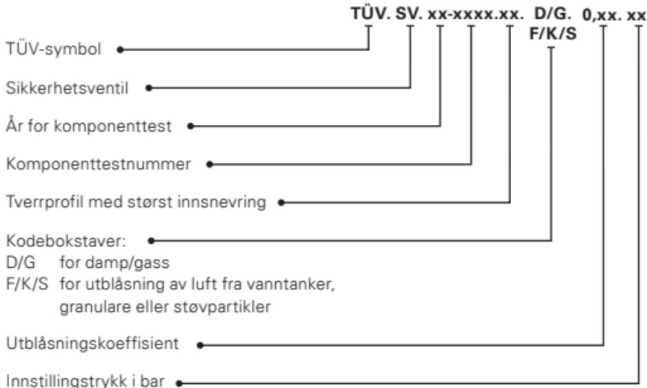
Vi kontrollerer sikkerhetsventilene for trykkmotstand og stramhet, justerer påkrevd innstillingstrykk og forsegler dem.
