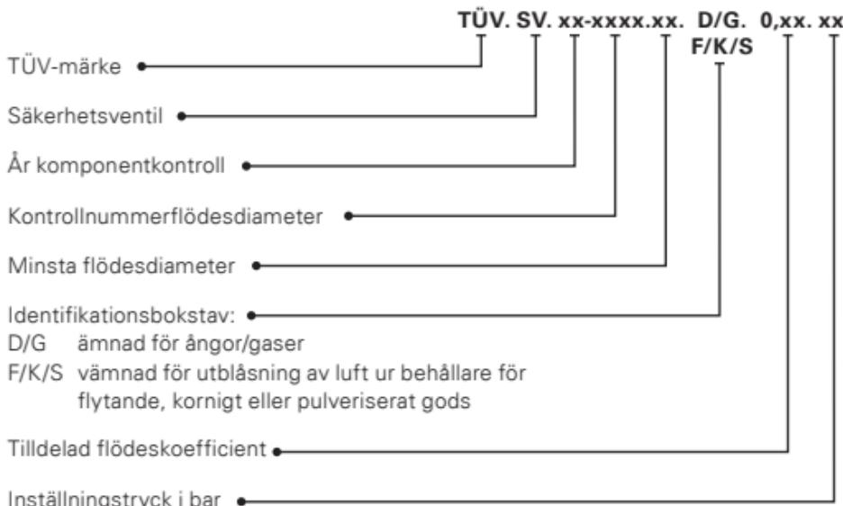
Säkerhetsventilerna kontrolleras på tryckhållfasthet och täthet, justeras in på önskat inställningstryck och plomberas.
