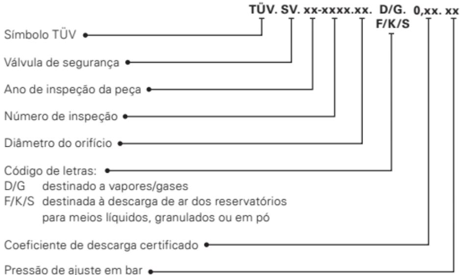
As válvulas de segurança são testadas por nós para resistência à pressão e estanqueidade, ajustadas à pressão de ajuste desejada e vedadas.
