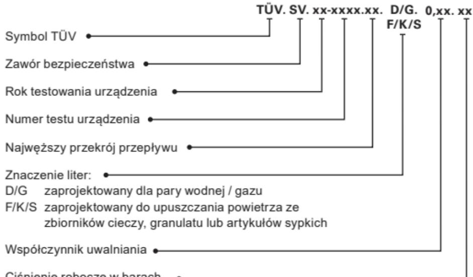
Sprawdzamy zawory bezpieczeństwa pod kątem odporności na ciśnienie i szczelność, ustawiamy ciśnienie robocze według wymagań klienta i plombujemy je.
