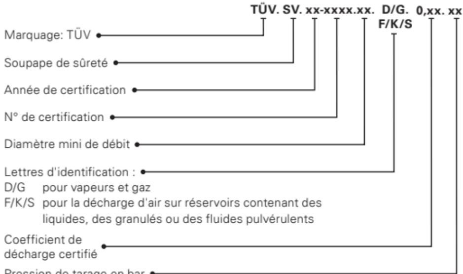
Nos soupapes de sécurité sont contrôlées quant à leur résistance à la pression et à leur étanchéité; elles sont réglées à la pression de tarage souhaitée et dotées d'un plombage.
